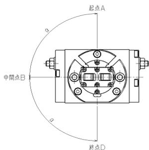
印加により、起点Aから反時計回りに回転します。
