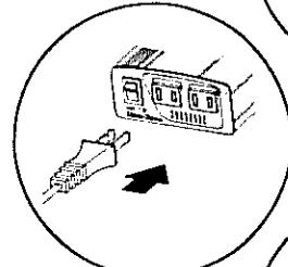
3 使用する電気製品のACプラグを本機のACコンセントに差し込みます。
