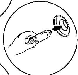
2 シガーソケットに、本機のシガープラグを確実に差し込みます。
