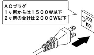
8. 電気製品のご使用後は、必ずACプラグを抜いて、本機のパワースイッチをOFFにしてください。
